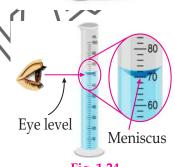
Fig. 1.24 Measuring Cylinder
